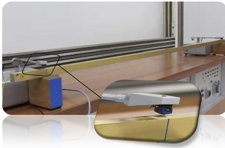
Abbildung 1: Messvorrichtung mit Plattenspielnadeln zur Wellenpulsdetektion
