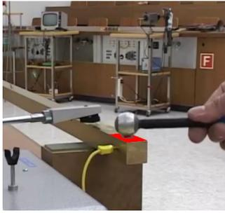
Wird hingegen der Messingstab an der Deckfläche angeschlagen, (vgl. Abbildung 4) so bildet sich eine transversale ebene elastische Welle aus. Dabei hat der Schlag auf den Stab die Form einer Scherkraft.
