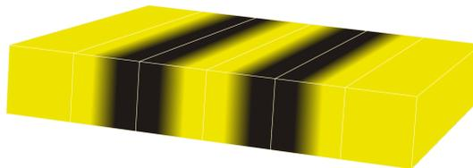
Abbildung 3: Longitudinaler Wellenpuls; die Farbabstufung beschreibt die Dichte der Welle
