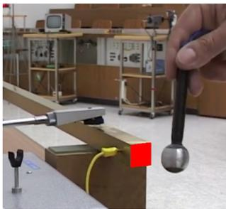
Wird der Messingstab wie in Abbildung 2 an der Querschnittsfläche angeschlagen, breitet sich eine longitudinale ebene elastische Welle aus. Die Wirkung des Schlages tritt in Form einer Oberflächenkraft auf.
